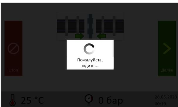
7.4. На этапе «Подготовка и торцевание» необходимо закрепить трубу в центриаторах и выполнить торцевание. Для перехода на следующий этап нажмите «Далее».
